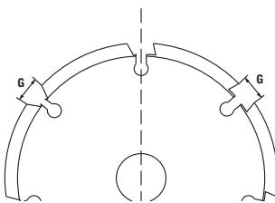
Сегменты должны иметь отрицательный передний угол, а ширина G между сегментами не должна превышать 10 мм. Толщина диска не должна превышать 2 мм.
